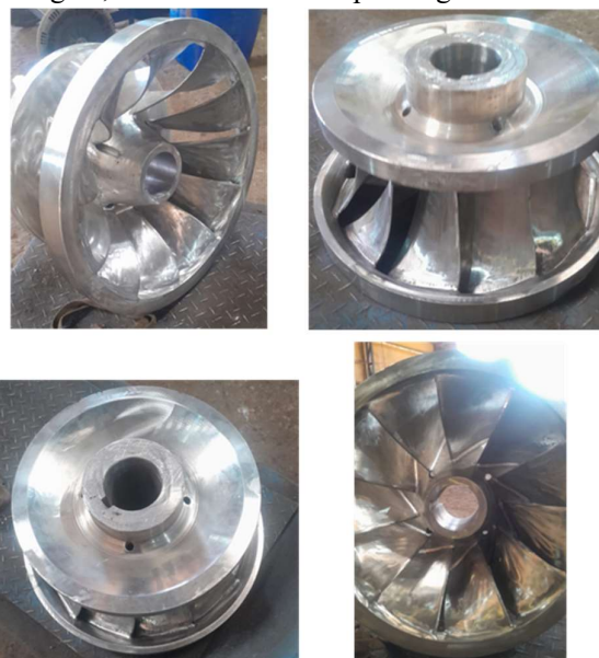
Figura 6.- Estágio de fabricação atual do novo rotor.
