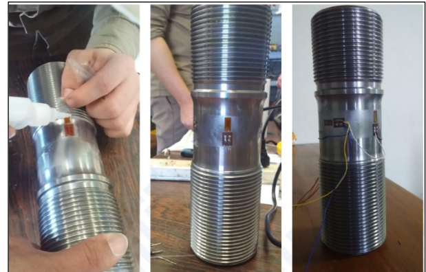
Figura 1. -Ejemplo de la instrumentación con galgas extensométricas en espárragos.
