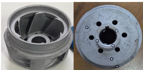
Figura 4.- Rotor centrífugo, D5=133,56 mm.
